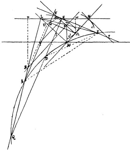
sons que le point  $H$  de l'adjointe  $n$  correspondant au point  $M$  s'obtient par la rencontre d'une parallèle à une direction fixe  $PM'$  menée par le point  $M$  et d'une parallèle à la normale  $MM'$  menée par le pôle  $P$ . Comme précédemment, nous avons le centre de courbure  $\Omega$  en élevant en  $M'$  à  $MM'$  la perpendiculaire  $M'L$  et en
