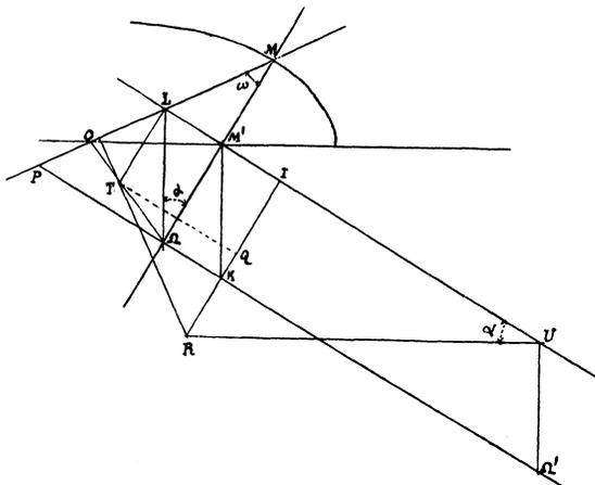
et  $L\Omega$  perpendiculaire à l'axe  $OM'$  (<sup>1</sup>), on construit le centre de courbure  $\Omega'$  de la développée par le tracé suivant, qui résulte de l'application directe de ce que l'on a vu plus haut (nos 3 et 4), avec la simplification indiquée au n° 7 :
