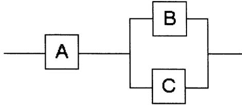
On note  $1 = ABC$ ,  $2 = ABC\bar{C}$ ,  $3 = A\bar{B}C$  les états de marche et  $4 = A\bar{B}\bar{C}$ ,  $5 = \bar{A}\bar{B}\bar{C}$  les états de panne.
