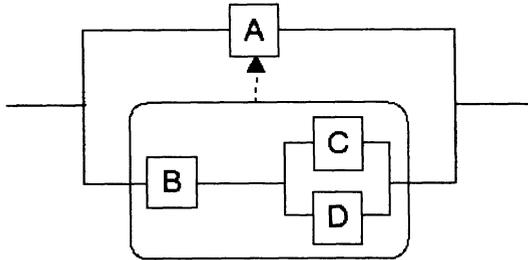
Les états de marche sont :  $1 = A(BCD)_a$ ,  $2 = \bar{A}BCD$ ,  $3 = \bar{A}BC\bar{D}$ ,  $4 = \bar{A}\bar{B}\bar{C}D$ , les états de panne :  $5 = \bar{A}\bar{B}CD$ ,  $6 = \bar{A}\bar{B}C\bar{D}$ ,  $7 = \bar{A}\bar{B}\bar{C}\bar{D}$ ,  $8 = \bar{A}\bar{B}\bar{C}D$ .
