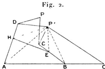
culées ensemble au point D, l'extrémité A étant un point fixe d'articulation; et un autre couple de deux tiges BC, CP' articulées ensemble au point C, le point
