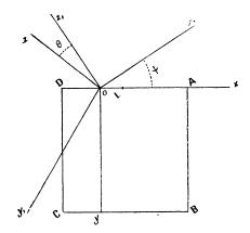
2° Ce côté DA glisse sans frottement sur un plan horizontal fixe  $x_1 O y_1$ .
