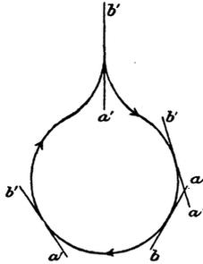
La tangente peut aussi se renverser après un passage du point  $c'$  par un point double à tangente double (fig. 7).
