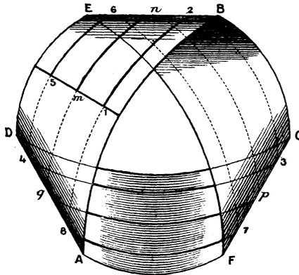
et que  $b'$  vienne en  $a$ , et qu'ainsi le sens de  $a'b'$  se trouve changé. On obtient de la sorte une surface développable qui n'a qu'un côté, comme on le voit en parcourant un contour fermé  $mnpqm$  qui est dessiné (*fig. 2*) ponctué en ses parties visibles à travers la bande.
